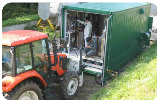
北海道開発局では、視察会場のインターファームにおいて、家畜排せつ物から発生するバイオガスを精製し、トラクタの燃料として使用する実証実験を行っています。
